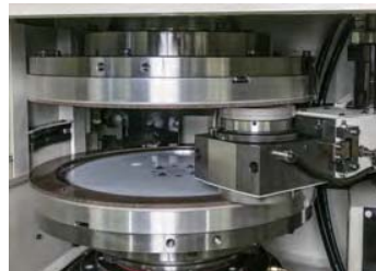
両頭平面研削盤 -上下砥石とロータリードレス
